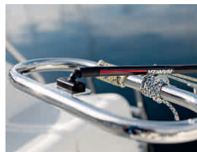
PINNE MIT AUSLEGER Sie dirigiert ein wohlbalanciertes Schwenkruder, der Ausleger ist ausreichend lang
