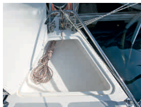
ANKERKASTEN Groß genug für Grundgeschirr und Festmacher, Fender müssen nach achtern
